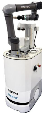
自社開発の用水サンプリングロボット 「MoMa-SLIM」
